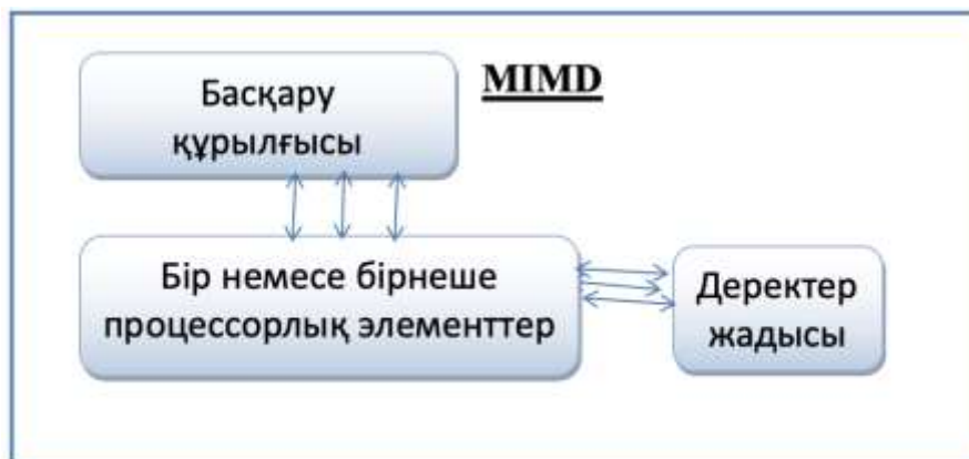
Сурет 5- MIMD бұйрықтардың көп ағымы және деректердің көп ағымы бар есептеу жүйесі
