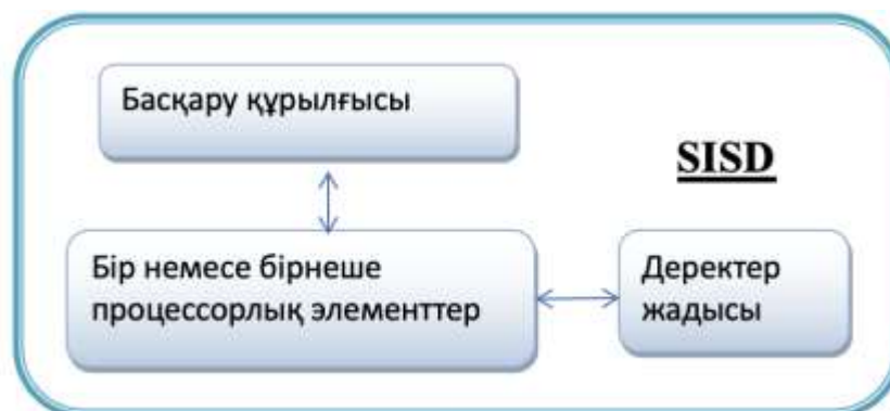
Сурет 2 – SISD бұйрықтардың да, деректердің де дара ағымдары бар есептеу жүйесі
