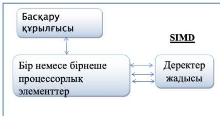
Сурет 3 – SIMD бұйрықтардың дара ағымы және деректердің көп ағымы бар есептеу жүйесі
