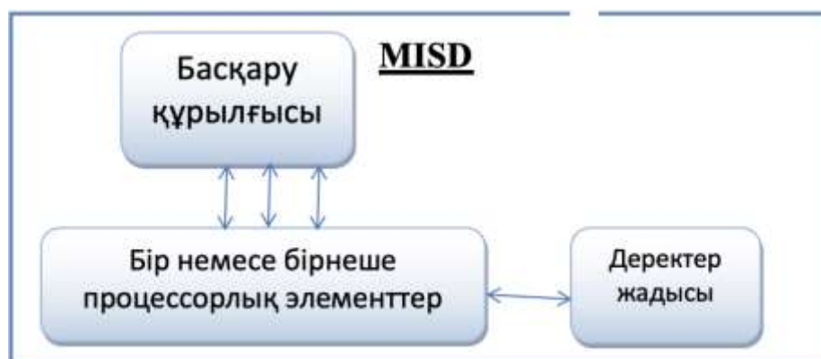
Сурет 4 - MISD бұйрықтардың көп ағымы және деректердің дара ағымы бар есептеу жүйесі
