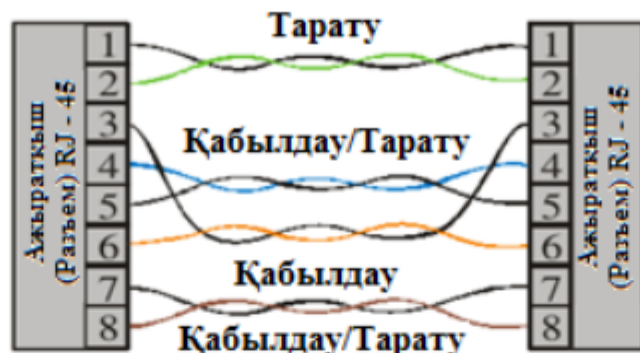
33 - сурет. 100Base-T4 спецификациясындағы төрт бұрмалау жұбы
