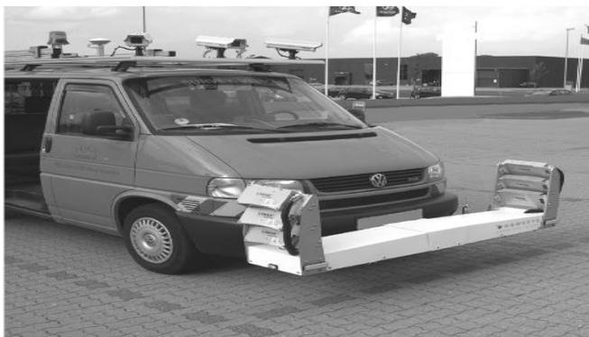
Рис.1. Профилограф для измерения поперечной ровности (глубины колеи)
