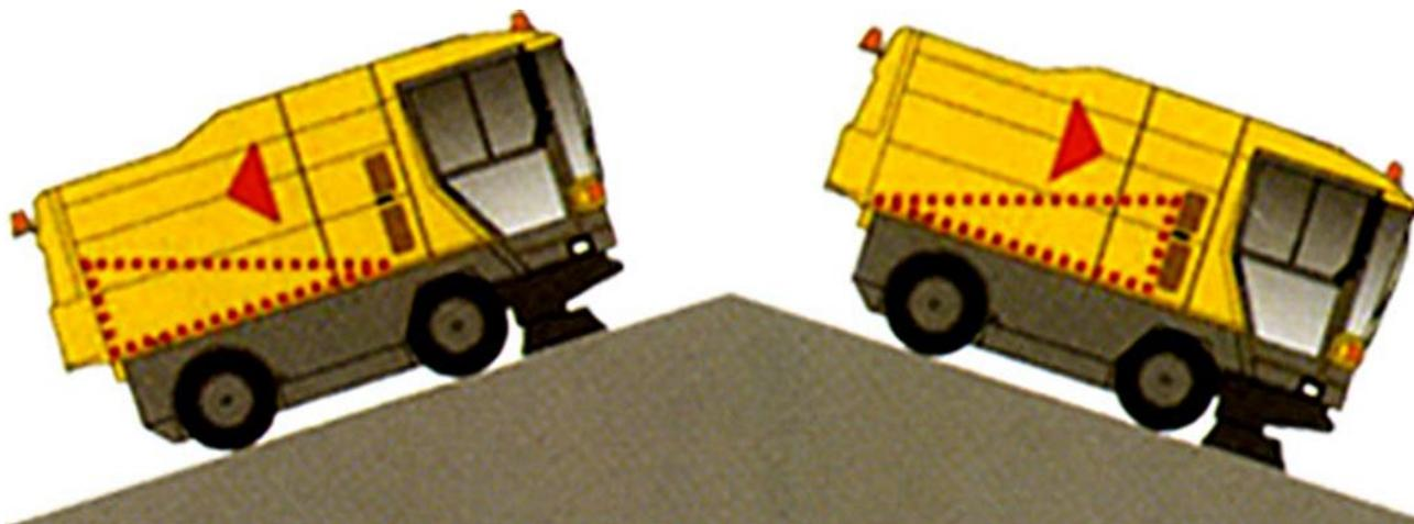
Продольный уклон характеризует величину проектных уклонов отдельных участков АД и расположение проезжей части относительно естественной поверхности земли, определяется тангенсом угла наклона  $\alpha$ .
