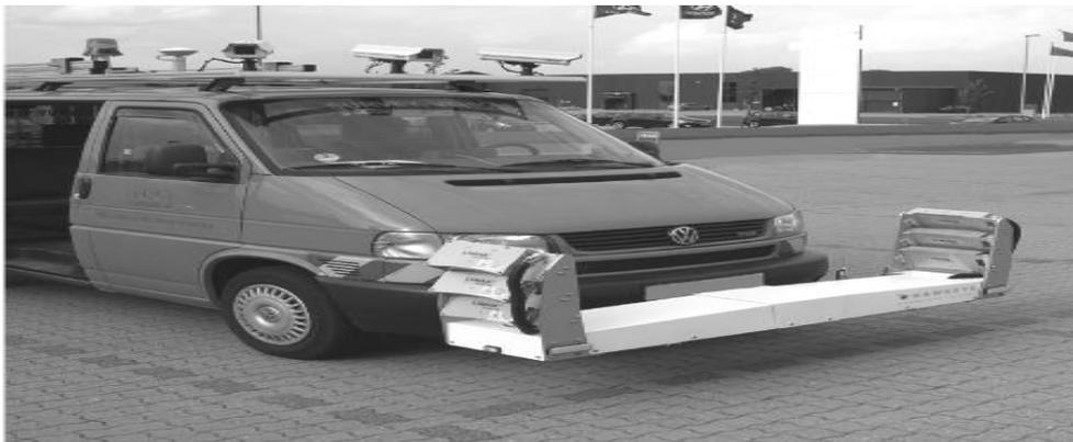
Рис.1. Профилограф для измерения поперечной ровности (глубины колеи)
