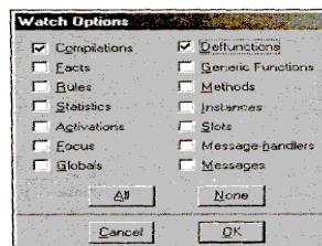
Рис. 32. Установка режима просмотра вызова функций
