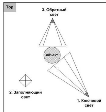
Рис. 12.6. – Расстановка источников методом треугольника, вид Top
